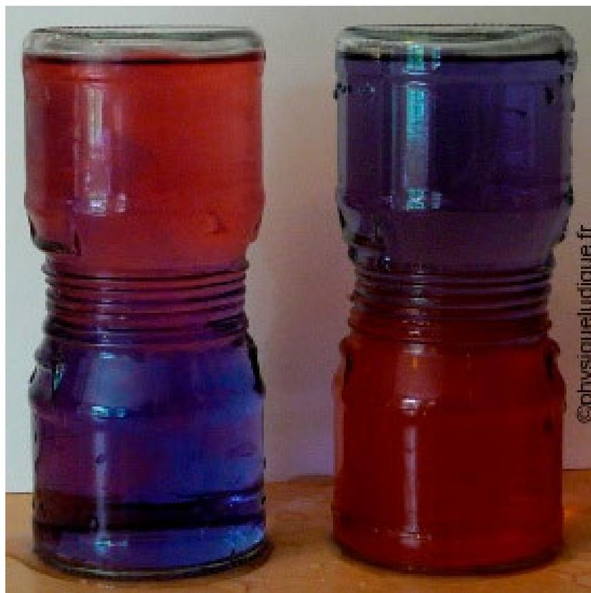
*L'eau chaude, ici colorée en rouge, reste au-dessus de l'eau froide plus dense colorée ici en bleu. Les deux eaux de densités différentes ne se mélangent pas dans ce cas, contrairement au cas où l'eau froide est placée au-dessus de l'eau chaude.*
