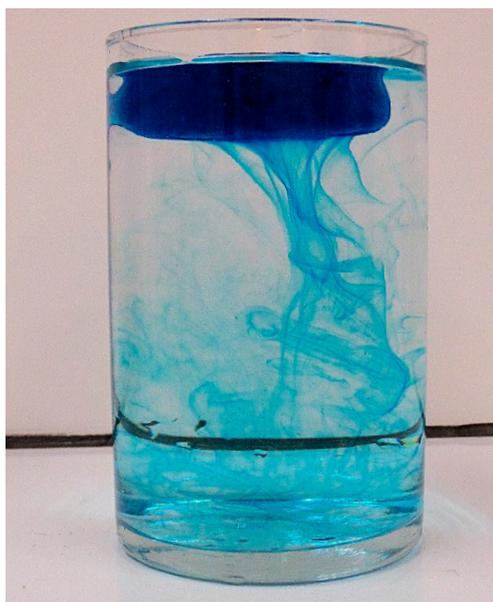
**La deuxième expérience** consiste à poser un glaçon, coloré en bleu pour faciliter la lecture du résultat, sur de l'eau à température ambiante non colorée. On peut alors observer qu'en fondant, le glaçon libère de l'eau froide qui plonge vers le fond du cristalliseur. Un filet d'eau colorée s'écoule vers le fond du récipient.
