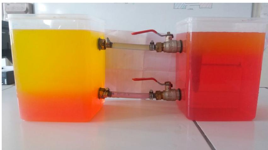
*L'eau froide rouge, dense, quitte le bac de droite et se dépose dans le fond du bac de gauche. L'eau à température ambiante, moins dense, jaune s'en trouve attirée dans le bac de droite et se place au-dessus de l'eau froide. On distingue les deux couches superposées.*
